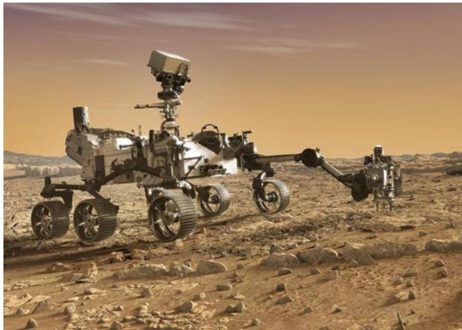
Perseverance are un design similar cu predecesorul rover, Curiosity, de la care a fost modernizat moderat; este dotat cu șapte instrumente principale, 19 camere și două microfoane. Roverul transportă, de asemenea, mini-elicopterul Ingenuity, un aparat de zbor experimental care va încerca primul zbor cu motor pe o altă planetă.
